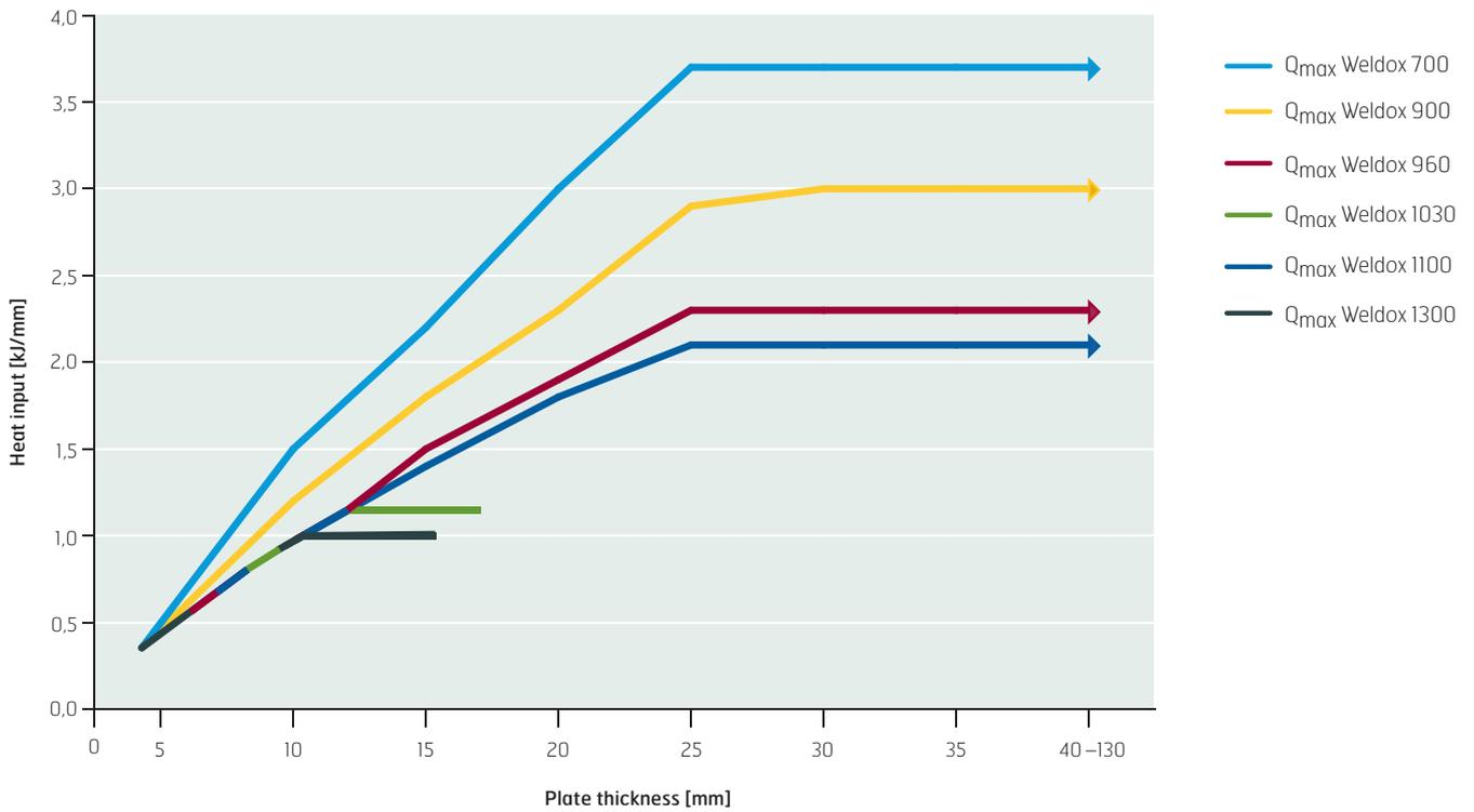
**RECOMMENDED MAXIMUM HEAT INPUT FOR HARDOX**
